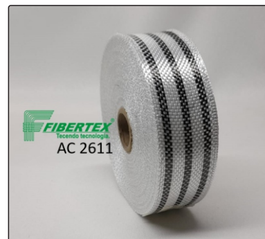
AC- 2611 Espessura: 0,25mm Largura: 40mm Comprimento do rolo: 50m
